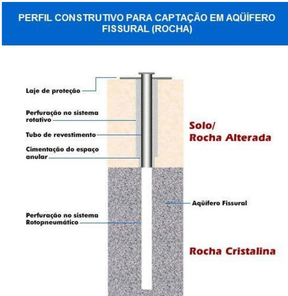
*Figura 5: Perfil Geológico e Construtivo do Poço Tubular*
